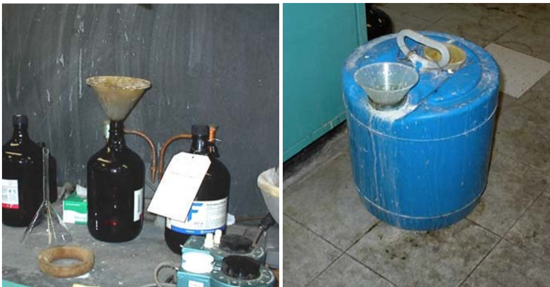
شکل ۷- باقیماندن کیف در دهانه باز ظروف پسماندهای شیمیایی خطرناک
